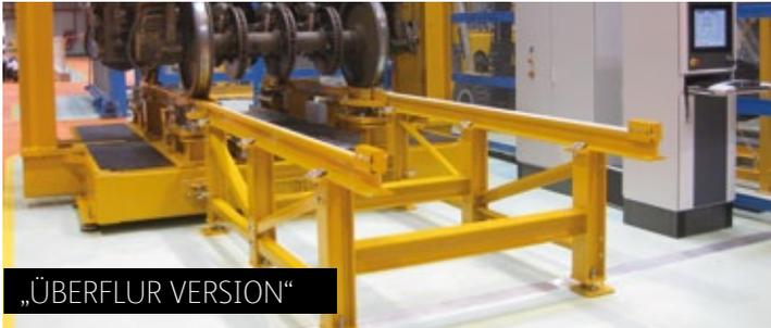
Drehgestell müssen zum Beladen und nachträglichem Entladen mit dem Hallenkran auf den Prüfstand gehoben werden. Integration in kundenseitige Montagestrasse möglich.
